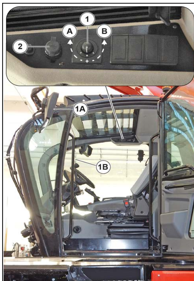
Afbeelding 55: Bediening van de achteruitkijkspiegels en USB-poort
